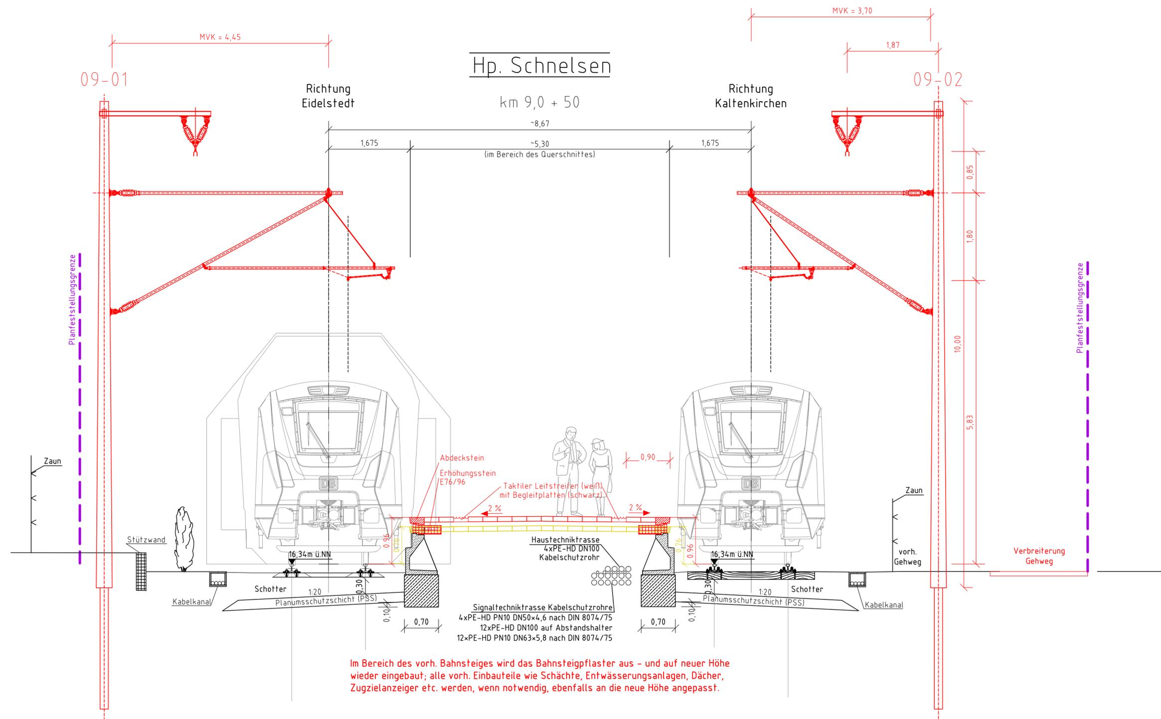
Im Bereich des vorh. Bahnsteiges wird das Bahnsteigpflaster aus- und auf neuer Höhe wieder eingebaut; alle vorh. Einbauteile wie Schächte, Entwässerungsanlagen, Dächer, Zugzielanzeiger etc. werden, wenn notwendig, ebenfalls an die neue Höhe angepasst.
